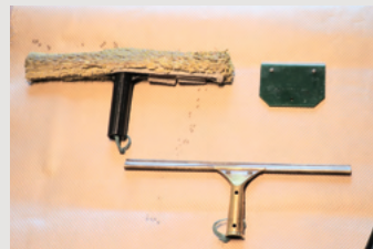
窓磨きに使うモップとスクイージー。右上の緑色のものは細かな汚れをそぎ落とす三枚刃。
