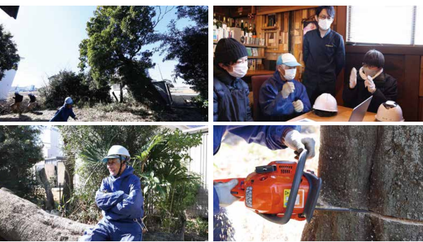
右上/安全に切り倒せるよう、綿索に打ち合わせ中 左上/倒す方向を決めチェーンソーで切っていきます 右下/計算通りの位置に倒れて大成功 左下/一仕事終わって満足そうな筒田さん
