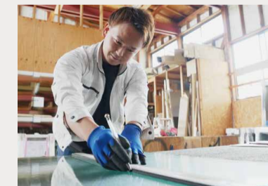
ガラス切りを使って作業中。角度と力加減が難しく、うまく切れているかは音で判断するそう。
